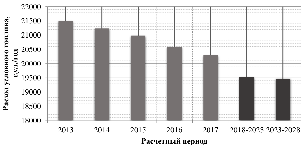
Рисунок 9 – Изменение годового расхода условного топлива ООО«ВБМ»(до 2017 года) /Котельной №11 (с 2018 года)
